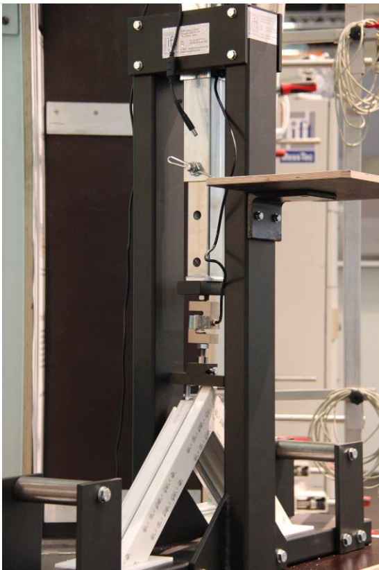
Bild 5 ift-Prüfgerät zur einfachen Kontrolle der Schweißbeckenverbindung und Beschlagbefestigung (TBDK-Prüfung)
