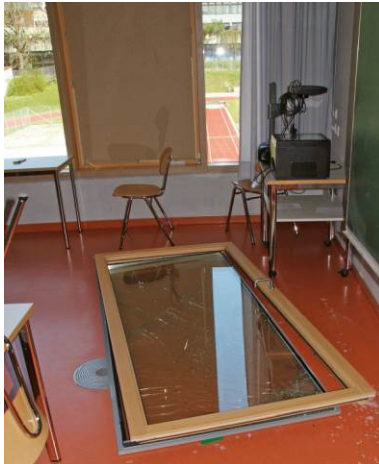
Bild 3 Bei schweren Fensterflügeln ist die richtige Beschlagauswahl besonders wichtig, um Unfälle durch herausfallende Flügel zu vermeiden
