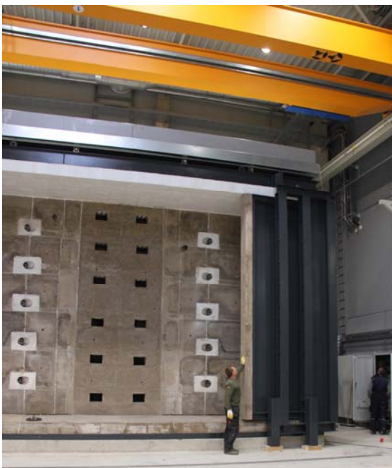
Bild 2 Der 8 x 5 Meter große Brandofen mit Krananlage setzt neue Maßstäbe für Brandschutzprüfungen
