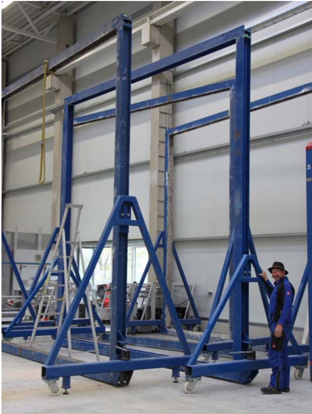
Bild 3 Die mobilen Montagerahmen sind Teil des Nutzungs- und Logistikkonzepts
