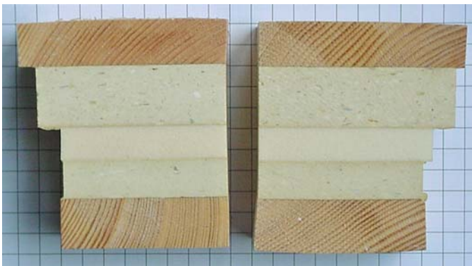
Bild 1 Im Rahmen des Forschungsvorhabens festgestellte Verformung von Decklagen, links mit radialer Jahrringlage, rechts mit weitgehend tangentialer Jahrringlage raumseitig [4]
