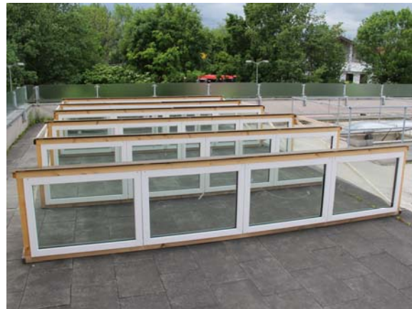
Bild 3 a) MIG-Probekörper mit Wegaufnehmern in der Klimakammer b) MIG-Probekörper in der Freibewitterung
