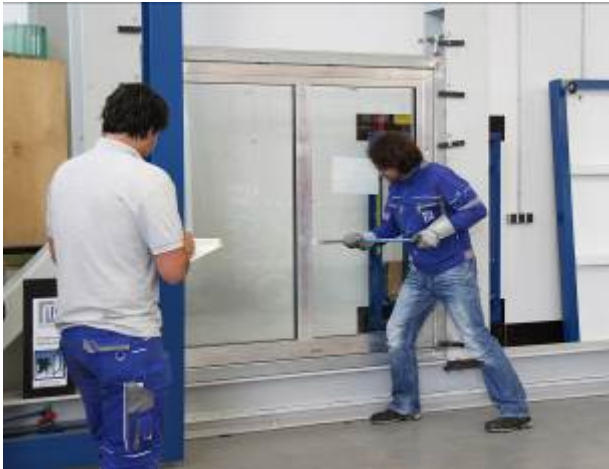
Bild 1 Prüfung der Einbruchhemmung im ift-Labor
