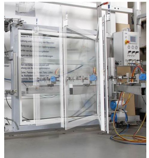
Bild 1 Prüfung der Dauerfunktion – Härtestest für Kunststofffenster-Systeme
