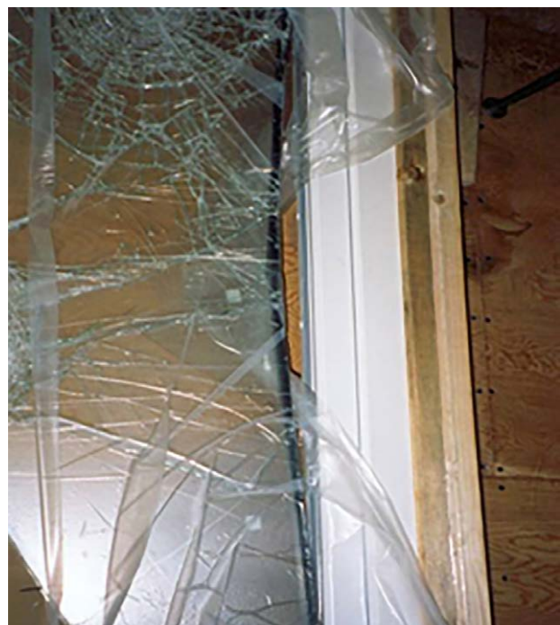
Bild 13 Prüfung von hurrikantauglichen Bauelementen im ift Rosenheim gemäß [20] (Quelle: ift Rosenheim)
