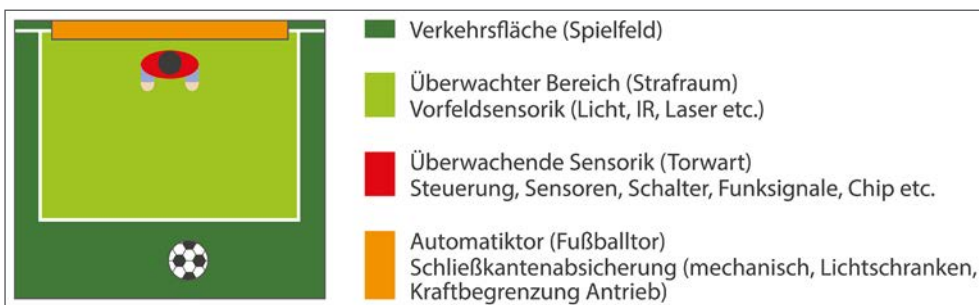
Bild 8 Funktion von Steuerung und Sensoren sind mit den Aufgaben eines Torwarts vergleichbar.
